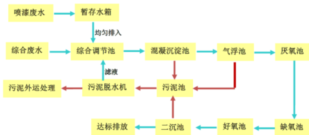
图 4-2 现厂区废水处理工艺流程图
