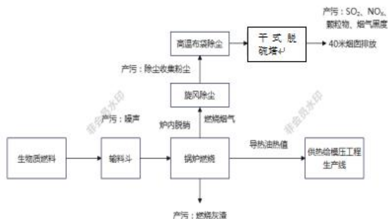
图 2-4 锅炉生产工艺流程及产污环节图
