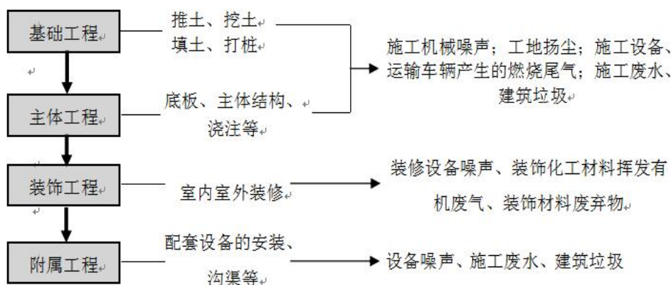
图 2-2 项目施工期工艺流程及产污情况图
