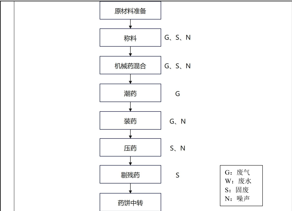
图 2-5 笛音效果件生产工艺流程及产排污节点图
