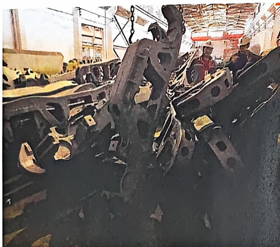
现场图 2：发生偏转的 ZBK1 侧架
