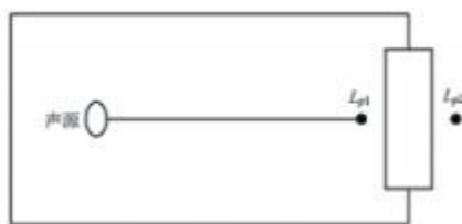
图 4-1 室内声源等效室外声源图例
