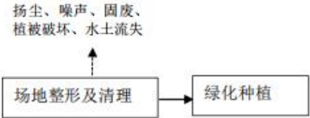
图 4-2 生态护坡施工工艺流程及产污节点
