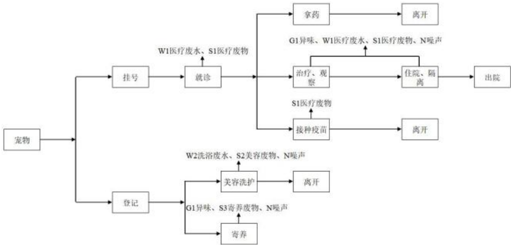
图 2-3 宠物诊疗流程及产污环节
