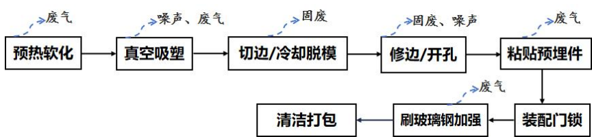
图 2-4 本项目前后顶工艺流程及产污节点图
