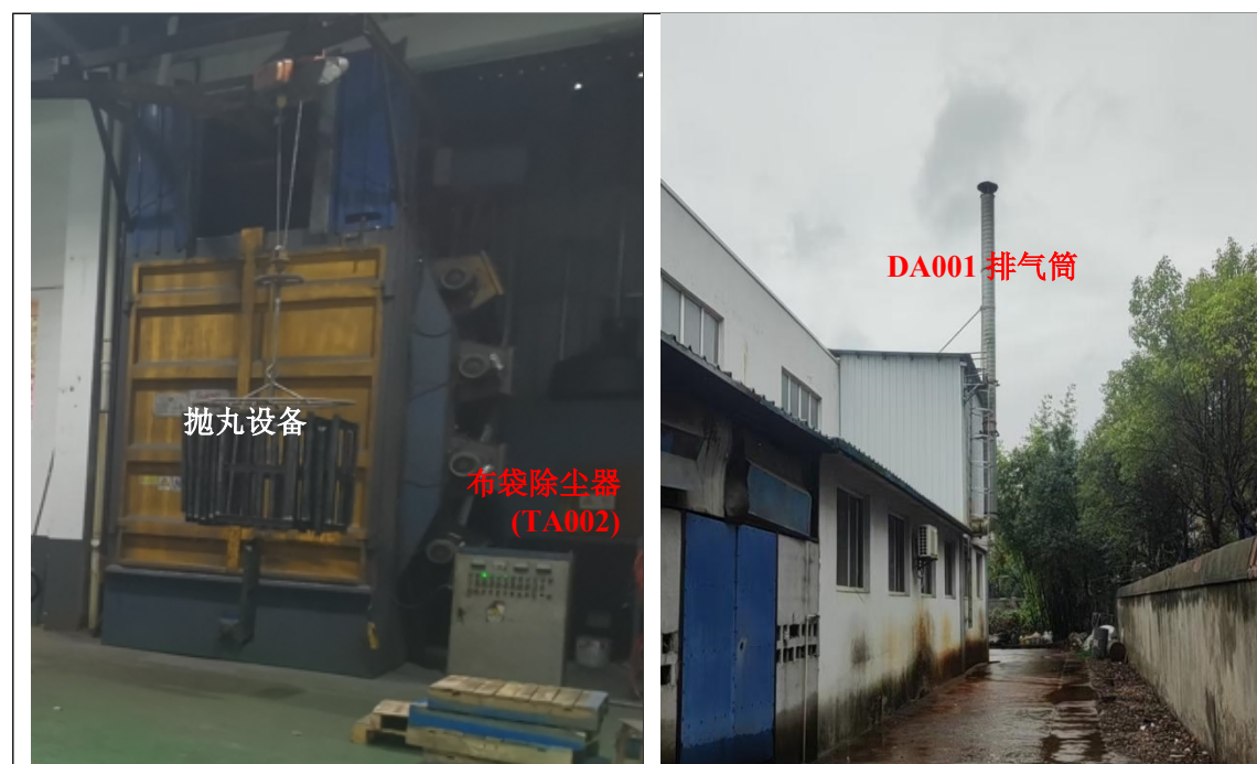
图 4-1 项目抛丸粉尘收集和处理设施现状图
