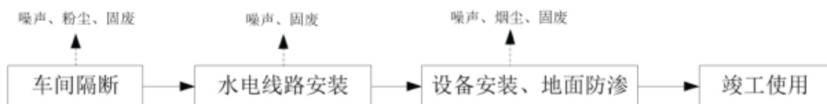
图 3.2-2 施工期工艺流程及产污节点图
