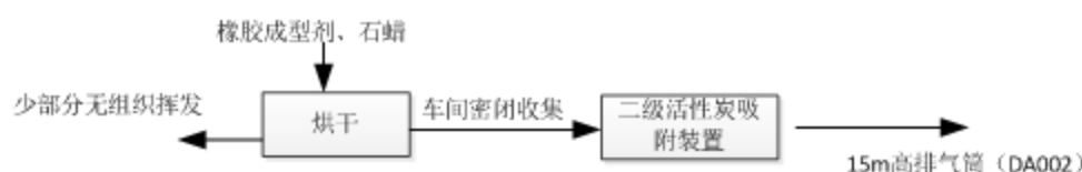
图 6.4-2 项目成型剂烘干有机废气处理工艺流程
