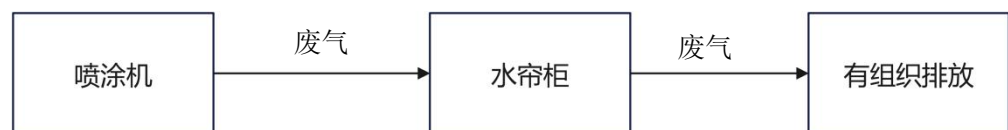
图 4-2 项目废气处理设施 (UV 生产区)
