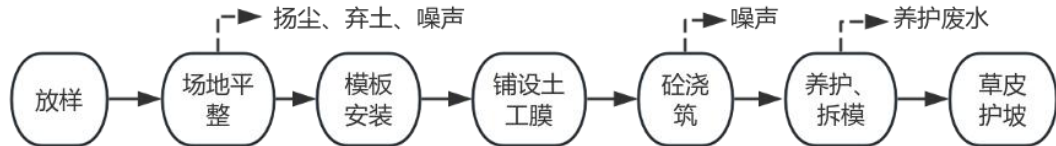
图 3.7-1 渠道防渗衬砌施工工艺流程及产污节点图
