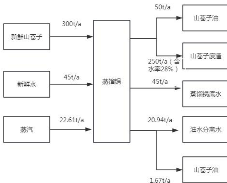
图1-5 物料平衡流程图
