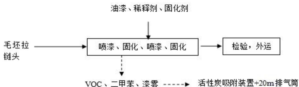
图 2-3 拉链头喷漆工艺流程及产污示意图
