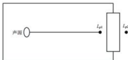
图 4-1 室内声源等效室外声源图例
