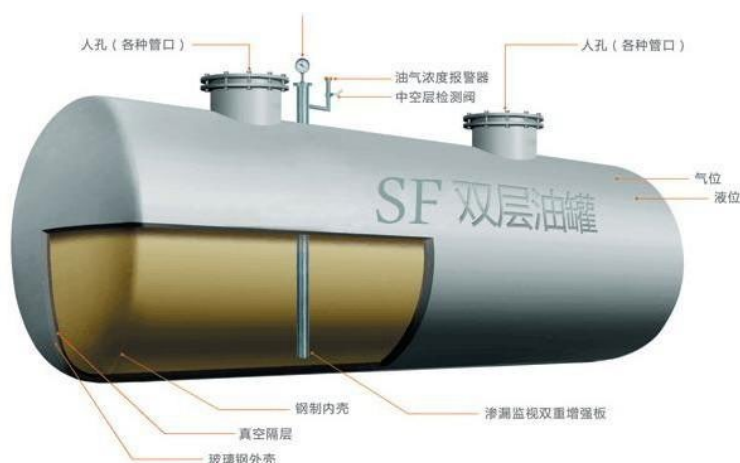
图2-6 SF 双层油罐剖面图
