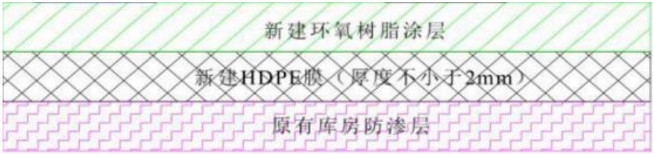
图 4-1 集中转运点防渗图层剖面图
