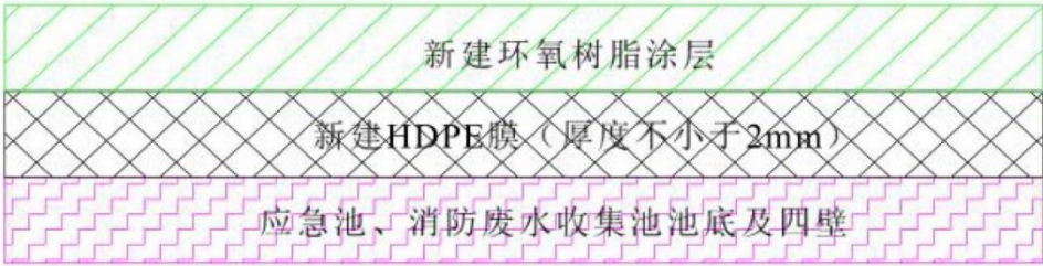
图 4-2 应急池防渗图层剖面图
