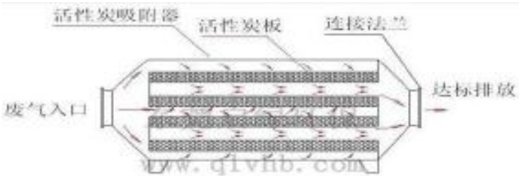
图 4-3 项目活性炭吸附器装置示意图
