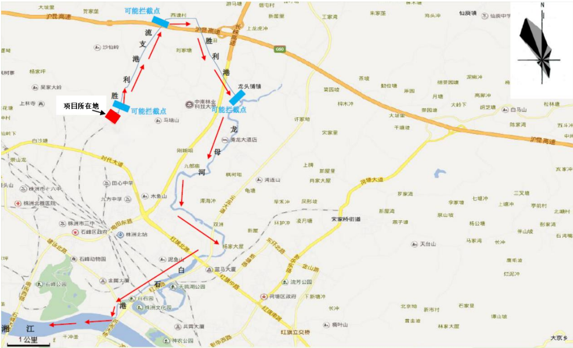
图4.8-1 防止事故废水进入外环境封堵系统图
