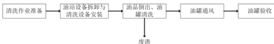
图 2-3 油罐清洗流程及排污节点图
