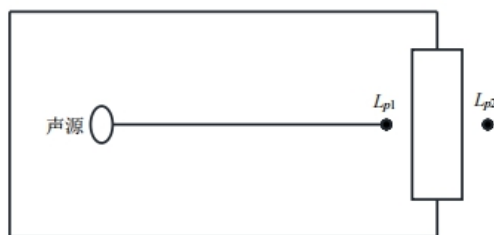
图 4-1 室内声源等效室外声源图例
