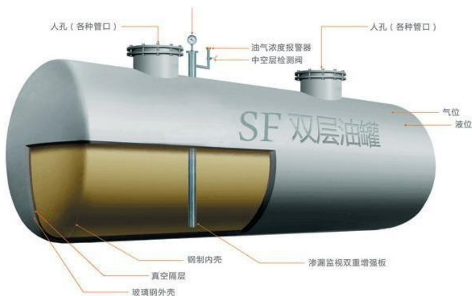
图4-2 双层油罐剖面图
