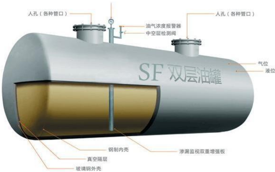
图2-7 双层油罐剖面图
