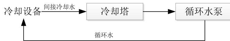
图 6.2-1 项目设备冷却水循环利用流程示意图
