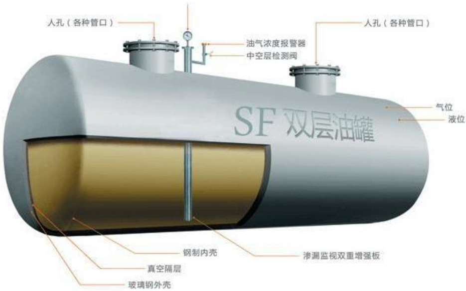
图2-7 双层油罐剖面图
