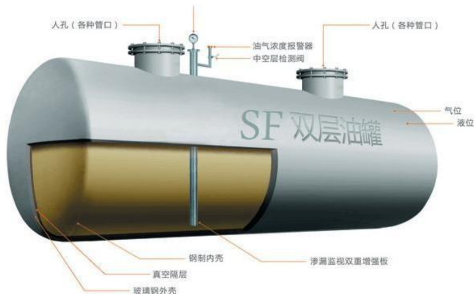
图4-2 双层油罐剖面图
