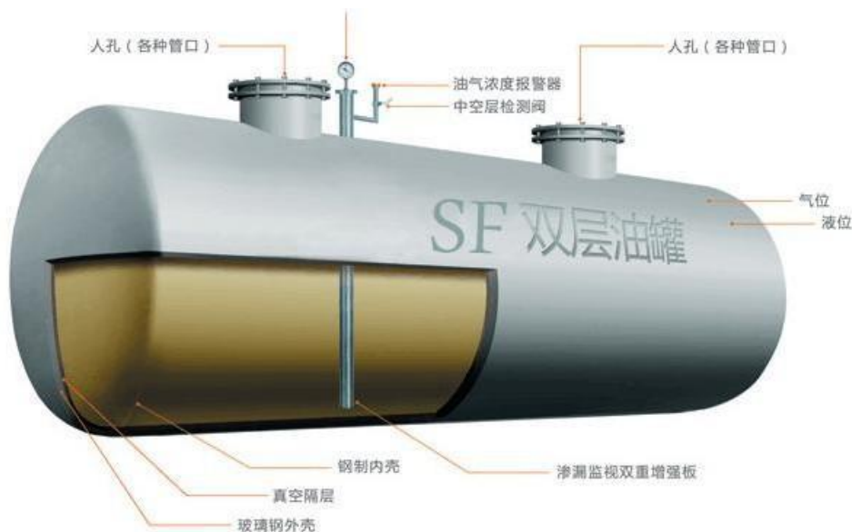
图2-7 双层油罐剖面图
