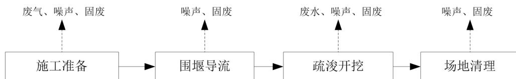
图 1-6 河道疏浚施工工艺流程及产污节点见图
