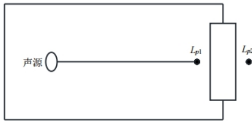
图 4-1 室内声源等效室外声源图例
