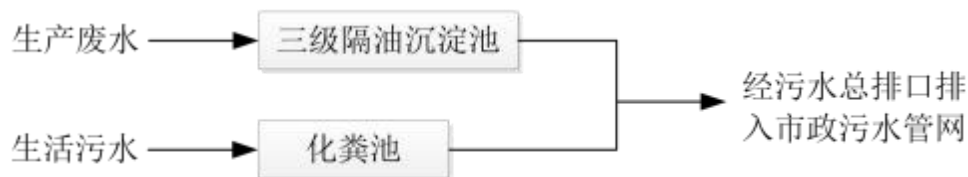
图6.2-2 项目污水处理工艺流程图
