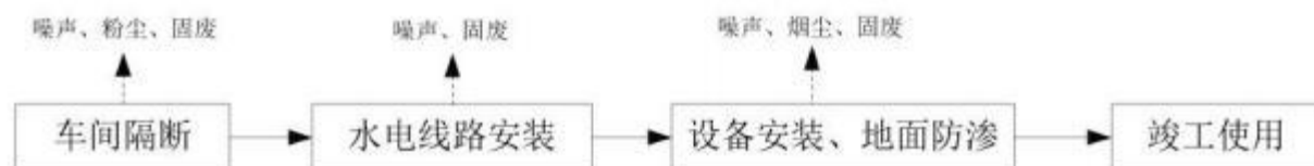
图3.5-1施工期工艺流程及产排污节点示意图
