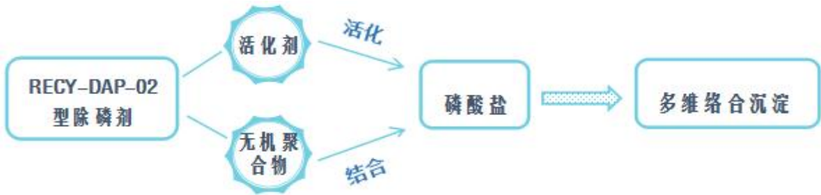
图 6.1-4 除磷剂处理原理
