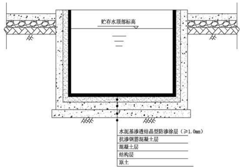
图 7.2-2 水池防渗结构示意图
