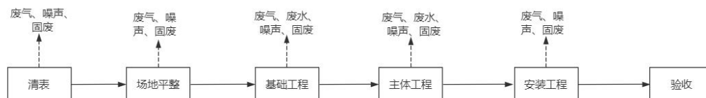
图2-1 施工期工艺流程及产污节点图
