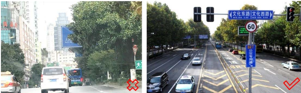
图 2.7.5-1 绿化植物不应遮挡交通标志的反例与正例
