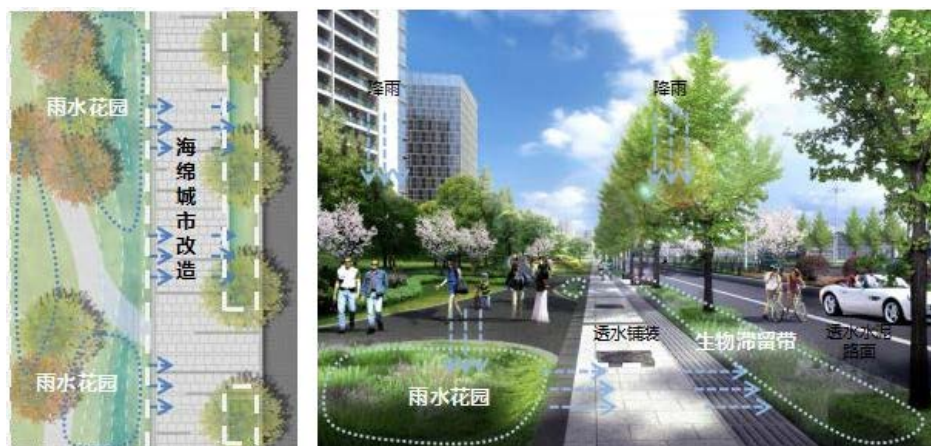
图 2.14.6-1 路侧绿带、退后空间海绵设计
