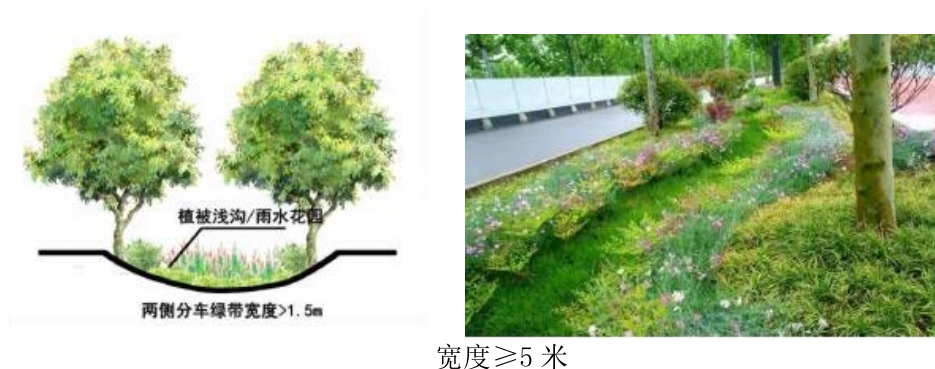
图 2.14.5-1 两侧分车绿带海绵设计
