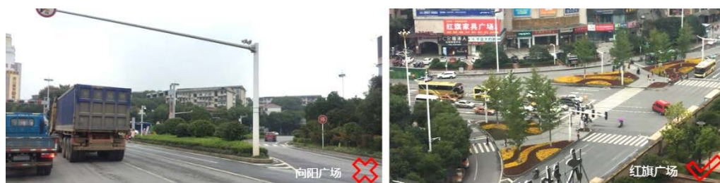
图 2.7.3-1 交通岛诱导度的反例与正例
