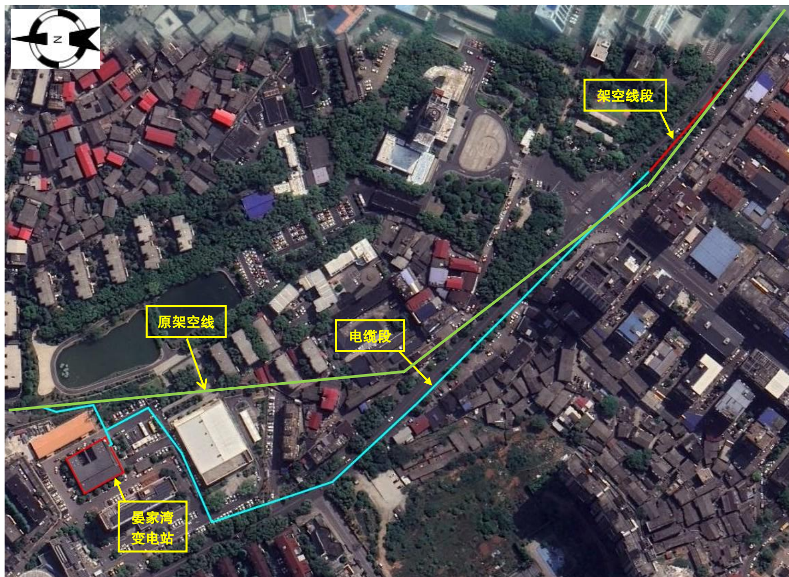
附图 3：湖南株洲荷塘区晏家湾 110kV 输变电工程线路路径示意图
