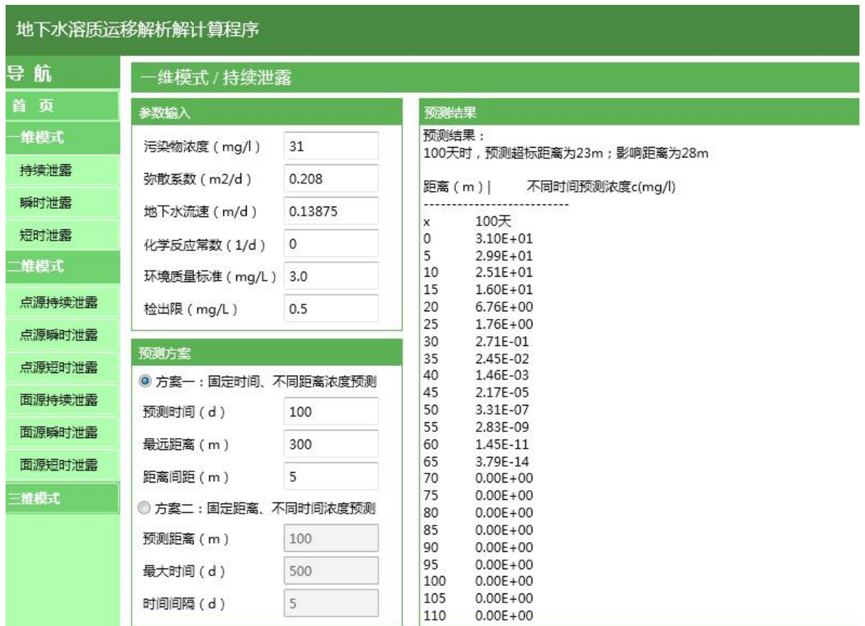
图 5.2-2 COD Mn 渗漏 100d 时间和位置变化的迁移结果
