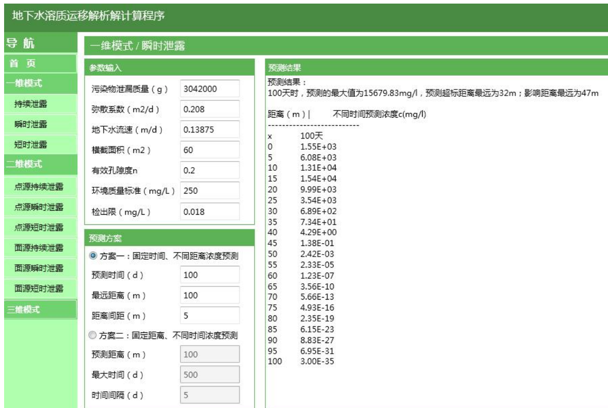
图 5.2-4 硫酸泄漏 100d 时间和位置变化的迁移结果
