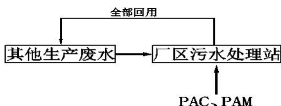
图 4-4 污水处理站处理工艺
