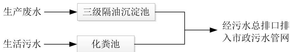
图 6.2-2 项目污水处理工艺流程图
