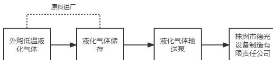
图 2-1.2 氮气直接输送工艺流程图
