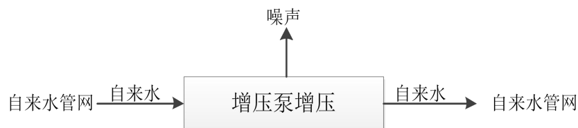
图 2-2 增压泵站工艺流程
