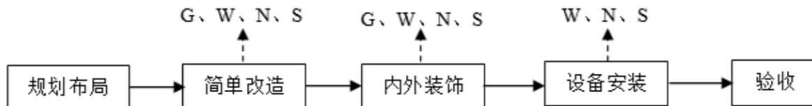
图 3.2-1 施工期工艺流程及产排污环节图
