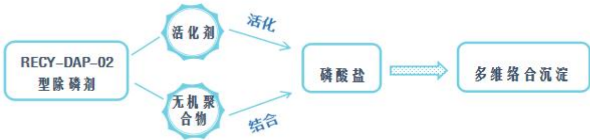
图 6.1-3 除磷剂处理原理
