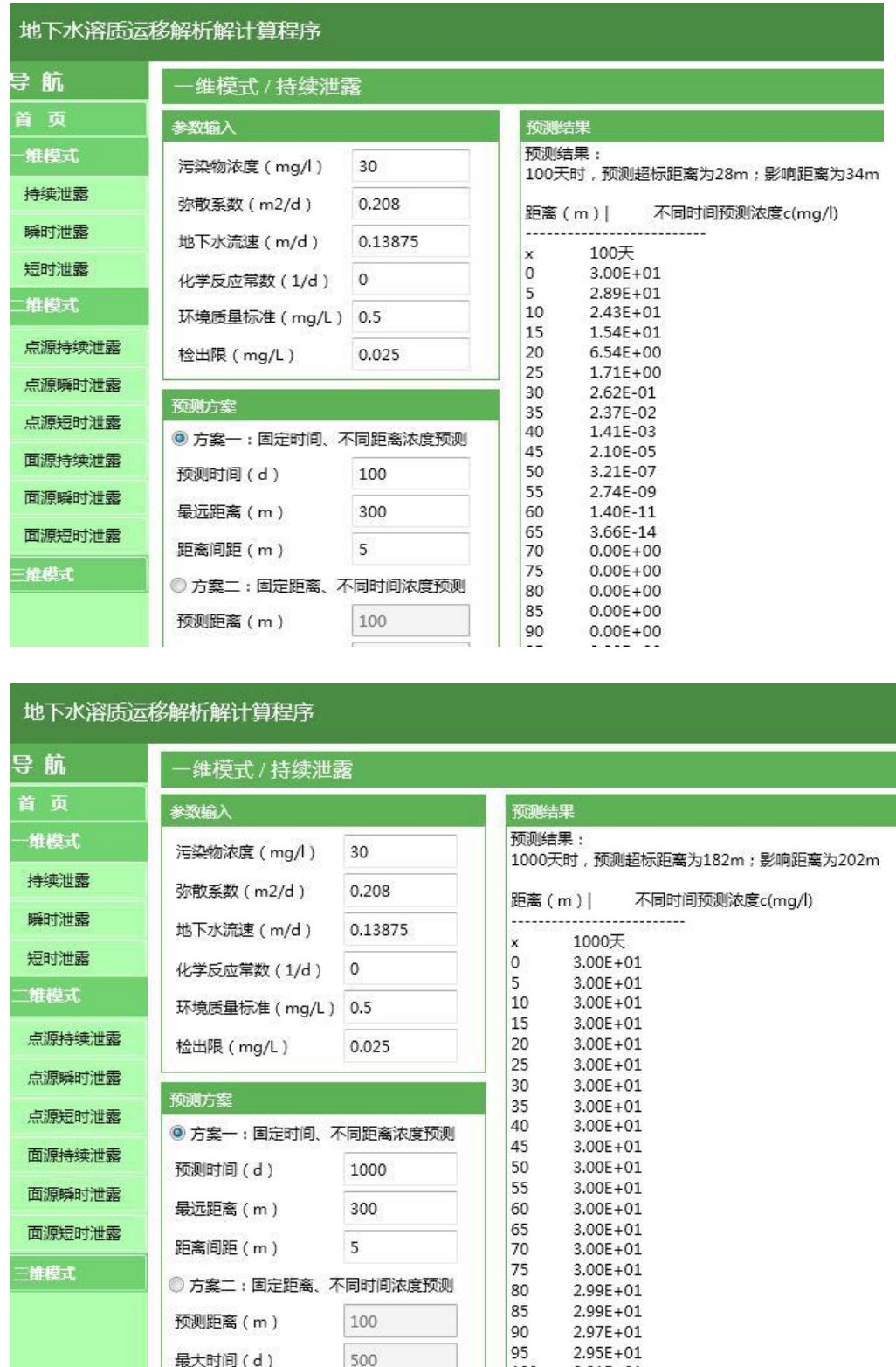
图 5.2-2 NH 3 -N 渗漏时间和位置变化的迁移结果
