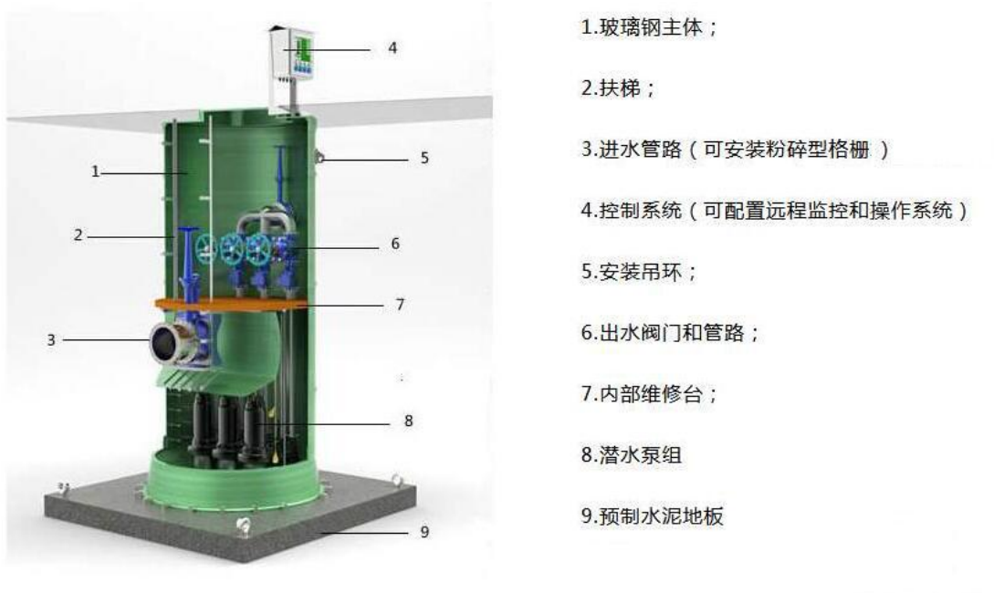
图 3.3-2 一体化提升泵站构成
