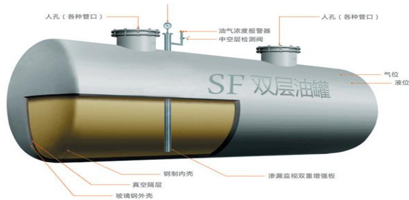
图 4-2 双层油罐剖面图
