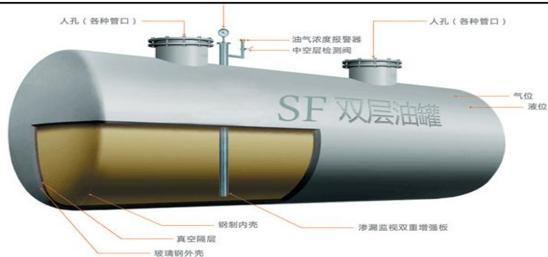
图 2-8 双层油罐剖面图
