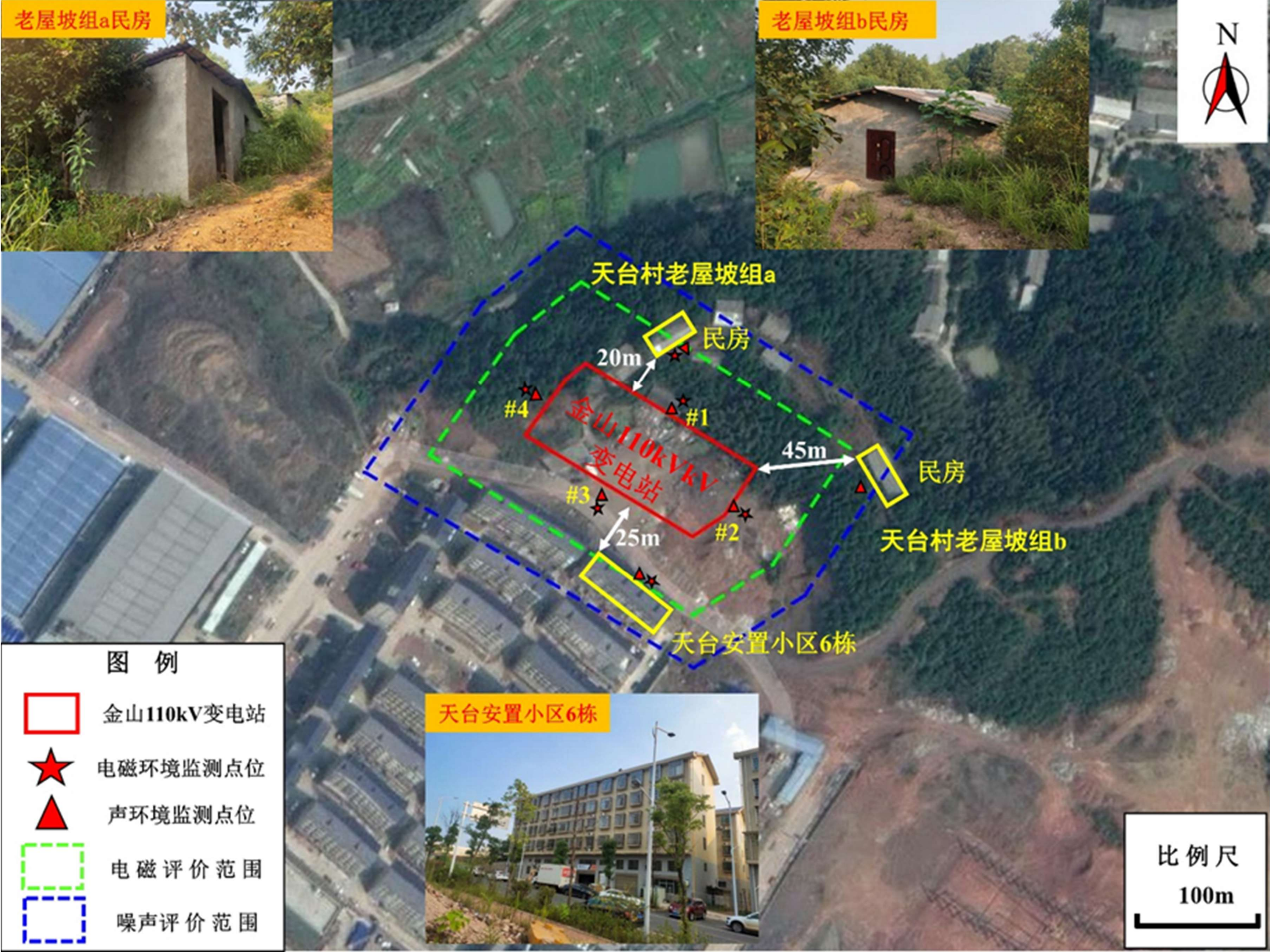
附图 4：金山 110kV 变电站工程监测点位示意图
