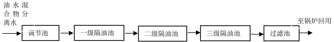
图4.3-1 三级隔油池工艺流程图
