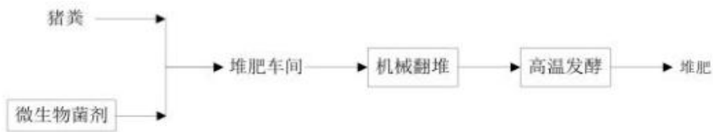
图 2.2-3 堆肥车间好氧堆肥工艺流程图
