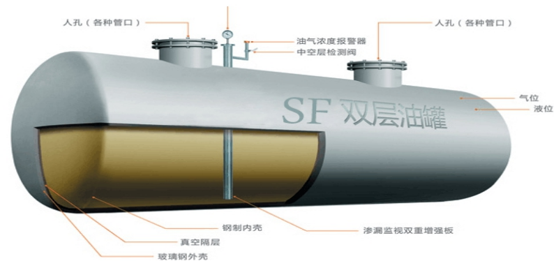
图 2-7 双层油罐剖面图
