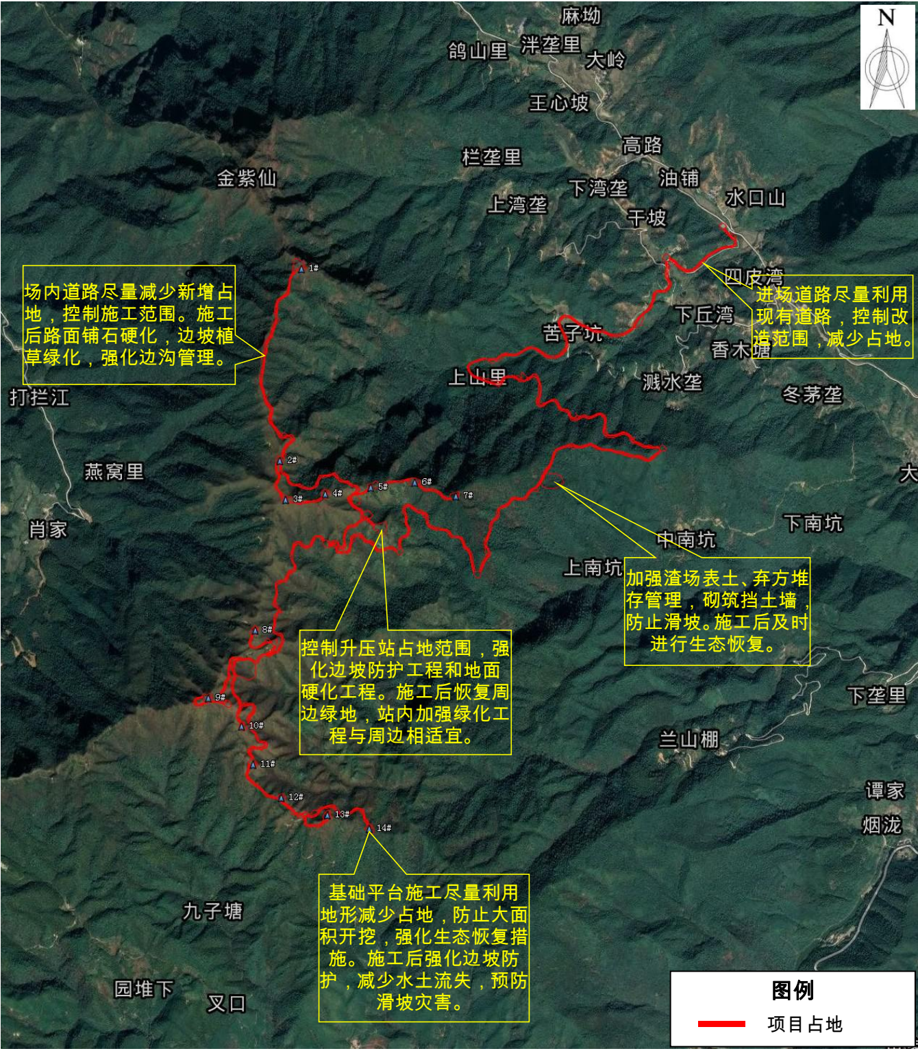
生态附图 5 典型生态保护措施平面布置示意图
