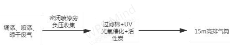
图4 项目调漆、喷漆、晾干废气收集、处理工艺流程图
