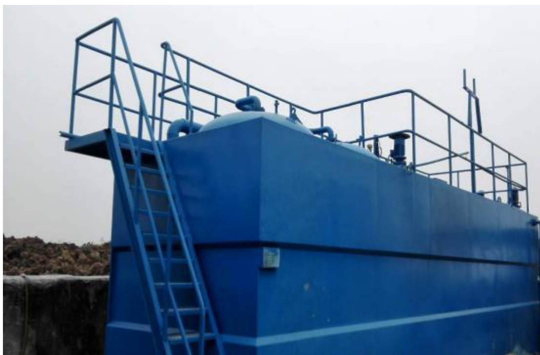
图 7-1 移动式一体化重金属废水处理设备
