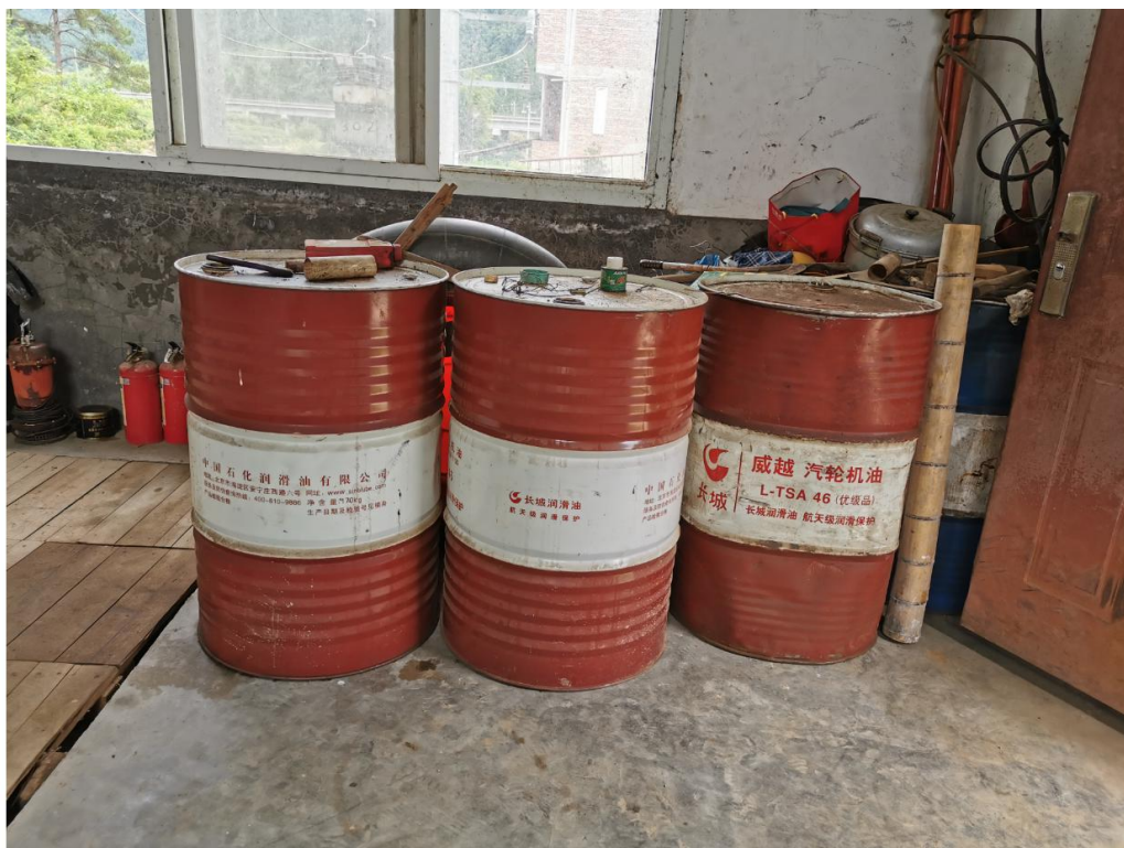
图 2.1-1 废油贮存现状
